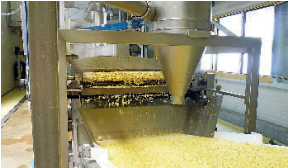
Verkürzter Kühlprozess: Die Kunststoffmodule speichern anders als Edelstahl keine Wärme. Das spart Zeit und Geld.
